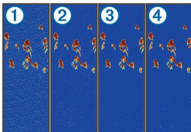
Al cambiar la configuración de interferencia de desactivada **1** a baja **2**, media **3** y alta **4**, el ruido se elimina gradualmente, pero el efecto es mínimo en los retornos intensos del objetivo. Para eliminar la interferencia de la pantalla, deberías utilizar la configuración de interferencias más baja mediante la que se consiga el resultado deseado. Corregir los problemas de instalación que provoquen ruido es la mejor manera de eliminar interferencias.
